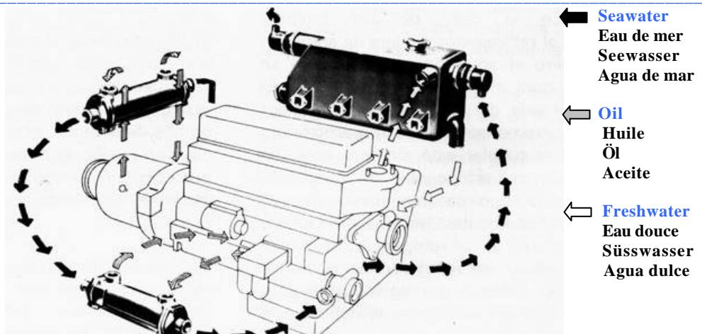
Diese typische Einrichtung zeigt die Stellung des Wärmeaustauschers, wassergekühlten Auspuffsammlerrohrs und der Ölkühler bei einem Schiffsmotor.
