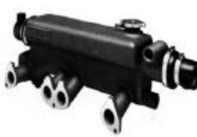
LR250-3736 Echangeur de chaleur, nourrice et collecteur d'échappement refroidi par eau combinés pour les moteurs diesel Land Rover à 4 cylindres de 2,3 et 2,5 litres.
