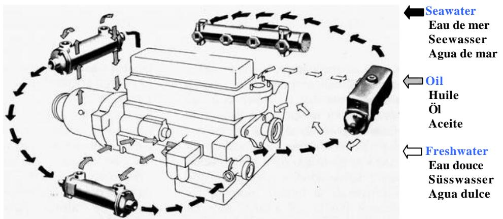
Diese typische Einrichtung zeigt die Stellung des Wärmeaustauschers, des seewassergekühlten Auspuffsammlerrohrs und der Ölkühler bei einem Schiffsmotor.
