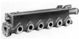
FM602 Ensemble spécial combiné comprenant échangeur de chaleur, nourrice et collecteur d'échappement refroidi à l'eau pour la série de moteurs 675/675T.
