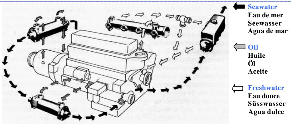
Diese typische Einrichtung zeigt die Stellung des Wärmeaustauschers, wassergekühlten Auspuffsammlerrohrs und der Ölkühler bei einem Schiffsmotor.
