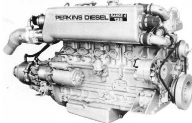
Moteur marin PERKINS 6-3544 équipé d'un ensemble échangeur de chaleur, nourrice et collecteur d'échappement refroidi par eau type PE580-3676.
