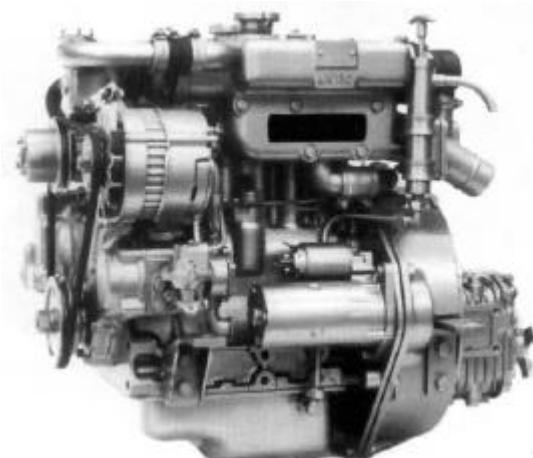
Moteur marin MITSUBISHI K3 équipé d'un ensemble échangeur de chaleur, nourrice et collecteur d'échappement refroidi par eau type MK130-3996.
