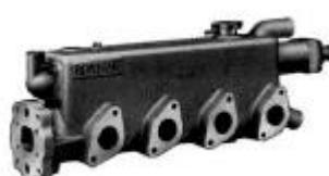
FM402 Ensemble spécial combiné comprenant échangeur de chaleur, nourrice et collecteur d'échappement refroidi à l'eau pour la série de moteurs 450/450T.
