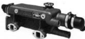
PE180-3483 Ensemble spécial combiné comprenant échangeur de chaleur, nourrice et collecteur d'échappement refroidi à l'eau pour moteur Perkins 4-99/107/108.
